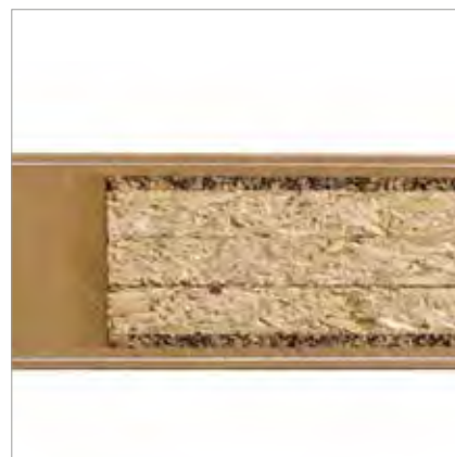
Insonorisation par structure multicouche.
